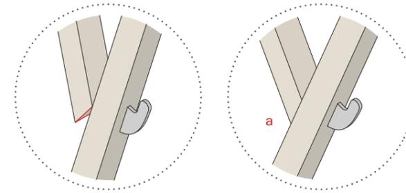
Zum Öffnen des Kleiderständers werden **rotierend** zwei der drei langen Stäbe an den oberen Enden gefasst und vorsichtig nach außen gezogen, bis der Garderobenständer komplett geöffnet ist (1 - 1 / 2 - 2 / 3 - 3).
