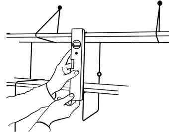
Nun können die weiteren Regalböden & Bügel im gewünschten Arrangement aufgehängt werden. Es sollte mit Hilfe eines rechten Winkels/einer Wasserwaage die Stellungen der Bügel ausgerichtet werden.
