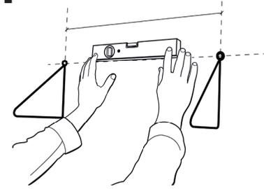
Der Abstand zwischen den Dreiecksbügel sollte bei einem kurzen Boden nicht kleiner als 55cm, bei einem langen Boden nicht kleiner als 85cm betragen. Die Linie zwischen den Bohrungen muss waagrecht sein, um ein gerade hängendes Regal zu gewährleisten.
