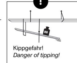
Beim Arrangieren der Bügel und Böden ist das Gleichgewicht der Konstruktion und die spätere Belastung zu beachten, um ein Kippen oder Herunterrutschen der Böden zu verhindern. Zusätzlich sollten mit den Sicherheitsklemmen die Regalböden fest mit den Bügeln verbunden werden. Vorbohren ist empfohlen.
