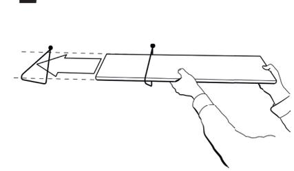
Nach Montage der Dreiecksbügel (in der Reihenfolge: Anzeichnen, Bohren, Dübeln, Anschrauben) folgt das Einlegen des ersten Regalbodens. Dabei empfiehlt sich das Brett diagonal in den Boden einzuschieben.
