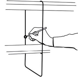
Jetzt können die restlichen Bohrlöcher markiert werden. Für ein sauberes Bohren empfiehlt es sich der Abbau das Regal bis auf den ersten Boden und die angeschraubten Wandhalterungen. Nach dem Bohren und Dübeln kann das Regal wieder im gewünschten Arrangement aufgebaut/festgeschraubt werden.
