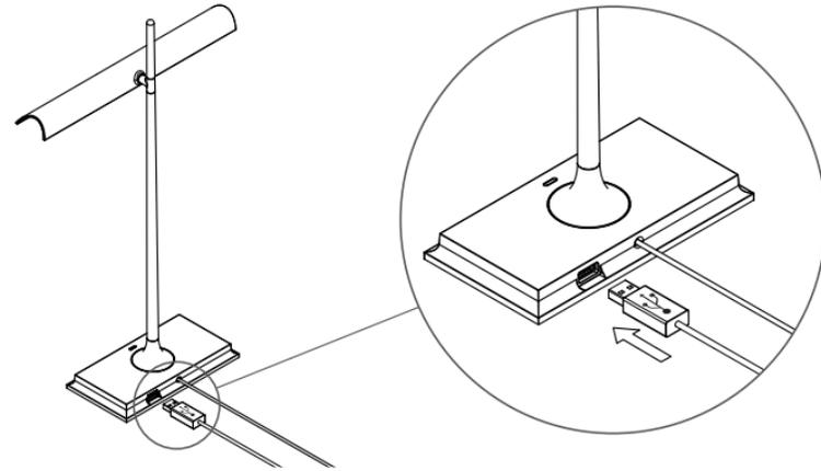
**IT** Fig.2 Il connettore USB permette la ricarica di dispositivi elettronici predisposti (5VDC 1,5A).
