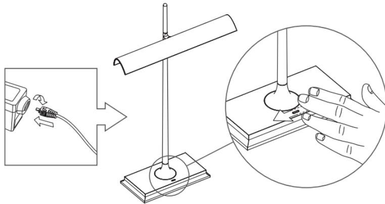
**J** 图1. 照明器具の点灯・消灯はセンサーに軽く触れて行います。最大/最小(50%) / 消灯の順に輝度が変わります。点灯した器具はセンサーに長いタッチをすることで100%まで光度を漸減させ、更にタッチし続けると100%まで増加します。望みの光度に達したらセンサーへのタッチを中止します。器具はリモコンで操作することもできます；調光器機能は光学センサーでのみアクティブ化されます。"「停電」により器具が消灯した場合、器具が線間電圧へ再接続しても、器具は消灯したままです。
