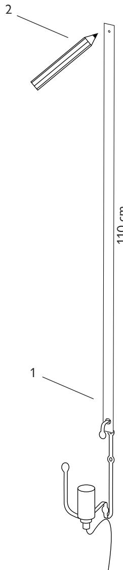
3. Untere Wandhalterung anzeichnen und bohren / Mark the bottom length and drill holes / Marquer et percer le support mural inférieur / Contrassegnare ed effettuare un foro per il supporto a parete inferiore
