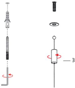
3. Stahlseil einstecken / Insert steel cable/ Insérer un câble en
