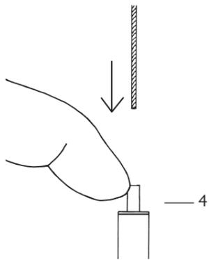
4. Lampenkabel anschließen / Connect lamp cable / Brancher
