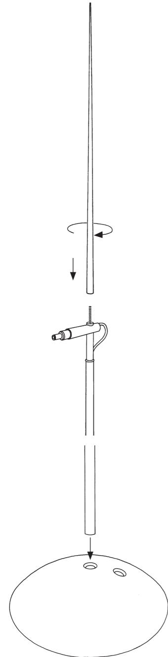
② Ring aufstecken / Attaching the ring / Insérer l'anneau / Inserire l'anello
