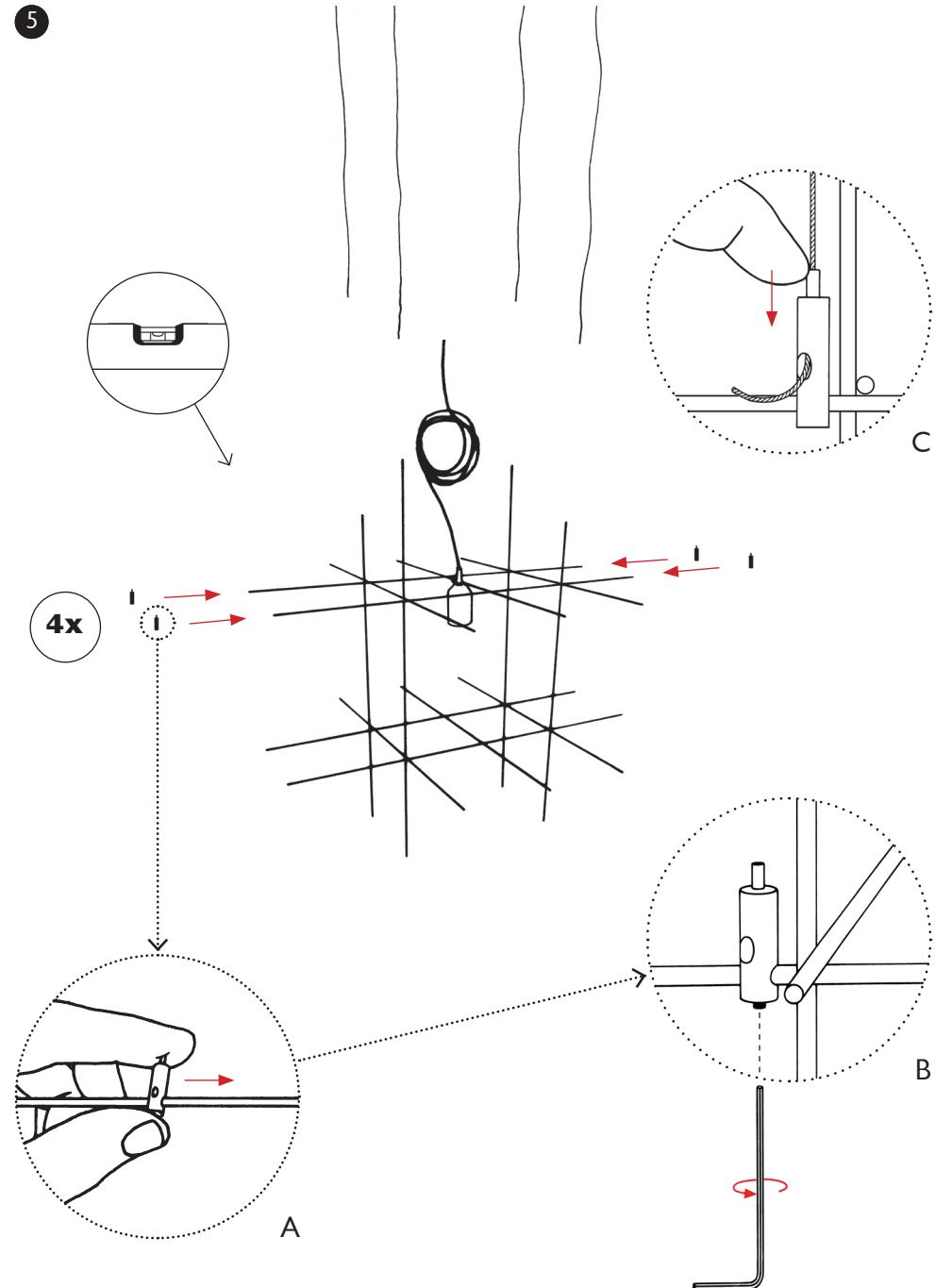
Blenden montieren / Attach the shades / Monter les écrans / Montare i paralumi
